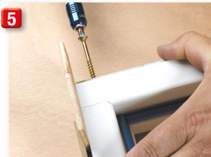
5 Assemblage du cadre par vissage des montants
