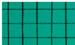
Tissu à bandelettes PEHD avec enductions PE sur les deux faces, renforcé sur les quatre côtés par des bandes à œillets pré-perforées et deux bandes réparties en milieu de bache (œillets espacés de 10 cm).
