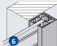
Jonction tablier / rails de guidage robuste et fiable : galets de guidage pour un maintien du tablier même en cas de fort vent
