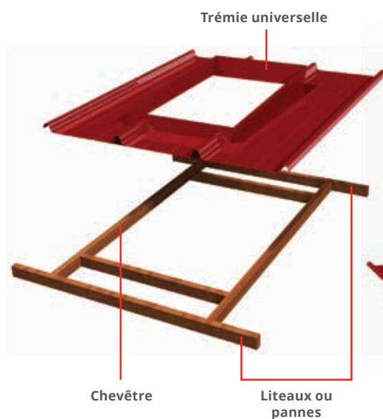
Mise en œuvre du chevêtre
