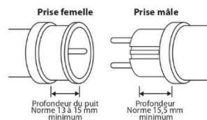
Bien qu'elles ne s'emboîtent pas complètement, l'indice de protection IP 44 reste en vigueur et est conforme à la norme NFC 61314.
