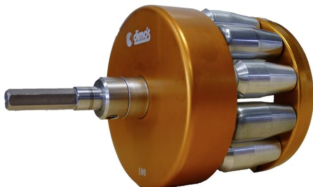
Les évaseurs permettent d'emboîter des tuyaux de diamètre identique en élargissant de façon uniforme l'extrémité d'un des deux tubes, garantissant ainsi un raccord propre et sans fuite.
