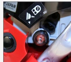
Pompe d'amorçage, démarrage rapide, corde de lanceur préservée
