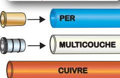
Si vous utilisez des tubes PER ou MULTICOUCHE vous devez mettre en place l'insert adapté avant la connexion.
