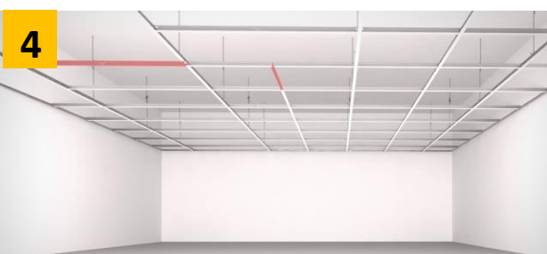
4. MISE EN OEUVRE DES ENTRETOISES
