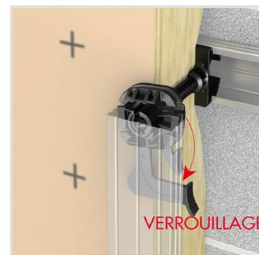
3. Placer un côté de la fourrure sur l'encoche de l'appui et la rabattre jusqu'au clipsage. Positionner une règle en appui sur la fourrure et régler l'aplomb par pression sur la tête de l'appui. Verrouiller par rotation horaire jusqu'à placer l'appui parallèle à la fourrure.
