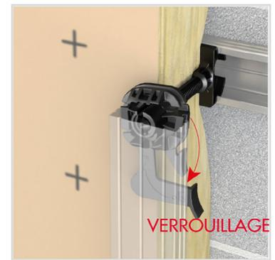
3. Placer un côté de la fourrure sur l'encoche de l'appui et la rabattre jusqu'au clipsage. Positionner une règle en appui sur la fourrure et régler l'aplomb par pression sur la tête de l'appui. Verrouiller par rotation horaire jusqu'à placer l'appui parallèle à la fourrure.
