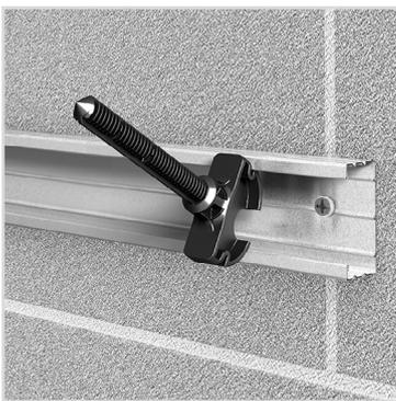
1. Positionner à l'horizontal une fourrure à 1,35m du sol fini à l'aide de vis adaptées au support. Clipser l'entretoise sur la fourrure.
