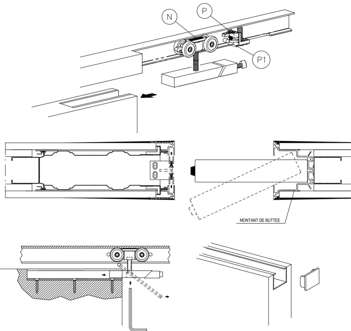
INTRODUIRE LES CHARIOTS (N) ET LA BUTEE D'ARRET (P) DANS LE LOGEMENT RESERVE. ACCROCHER LE VANTAIL AU CHARIOT AVANT, POUSSER LA PORTE A L'INTERIEUR DU MONTANT DE BUTTEE. INSERER L'ETRIER ARRIERE ET REGLER LE COULISEMENT.
