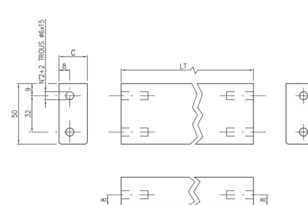
Il est conseillé de percer les montants sur les deux côtés du jambage pour en faciliter le montage.
